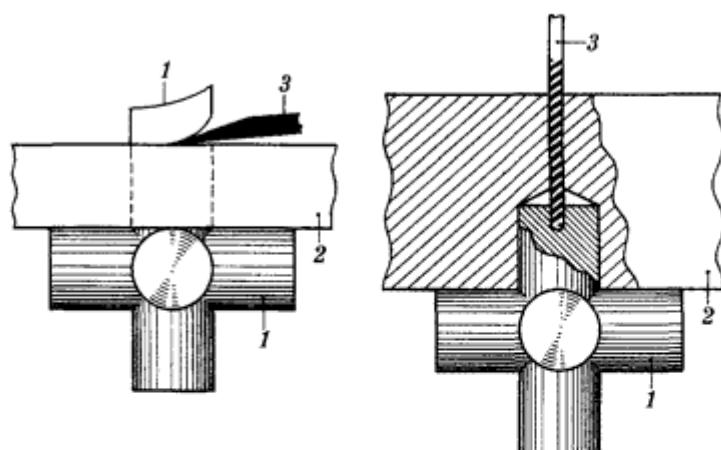
Рис. 11. 1 — крест; 2 — металлическая или плексигласовая планка с отверстием; 3 — нож.
