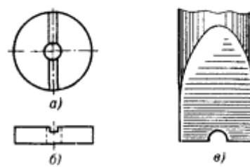
Рис. 13. а, б — гайка; в — отвертка.
